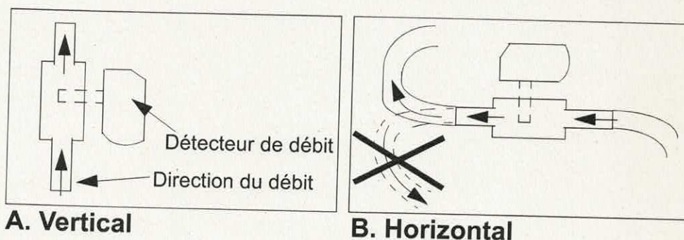
Figure 1: Attachez le détecteur de débit à un tube vertical.
