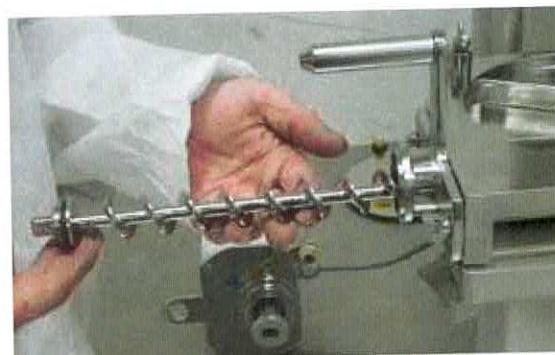
Retirer la vis d'alimentation en produit 511H
