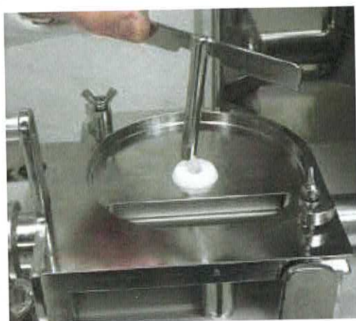
Retirer l'agitateur en le soulevant
