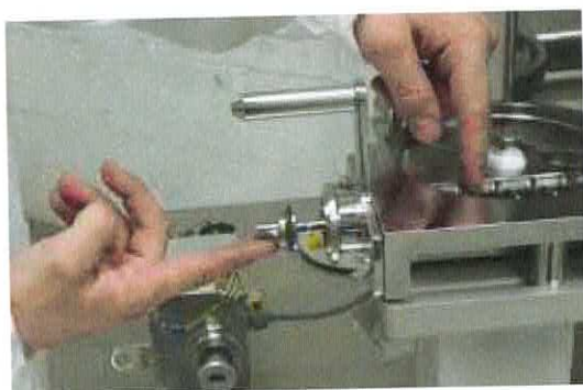
Retirer le collier clamp pour mettre de côté le moteur d'alimentation en produit
