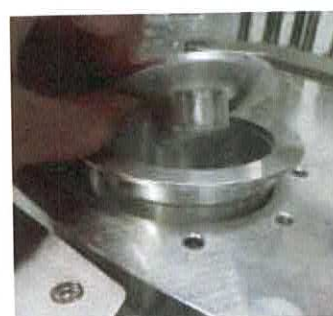
Mettre en place ou retirer les pièces « support de la capsule »
