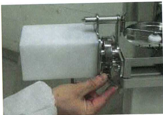
Retirer le collier clamp pour mettre de côté le moteur d'alimentation en produit
