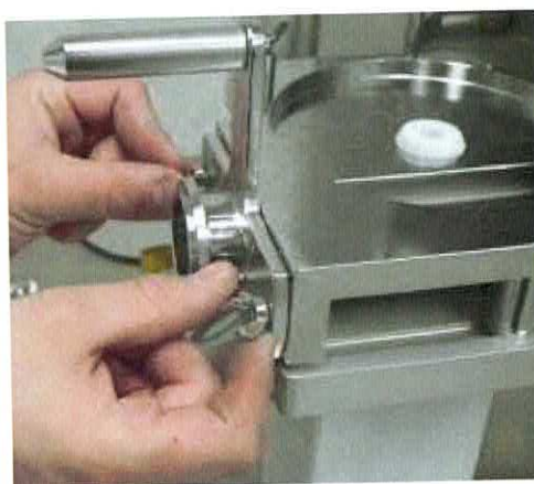
Retirer l'ensemble du maintien du moteur du 511H qui est fixé par deux écrous papillons
