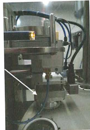
Résistance de chauffe et sonde de température
