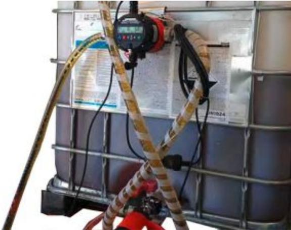
REPLISSAGE PRODUITS LIQUIDES SEMI AUTOMATIQUE A PARTIR D'UN CONTENEUR IBC AVEC 1 COMPTEUR DE DEBIT ET UN AMPLIFICATEUR DE COMMUTATION :
