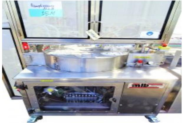
REPLISSEUSE OPERCULEUSE POUR PRODUITS ECHANTILLON
